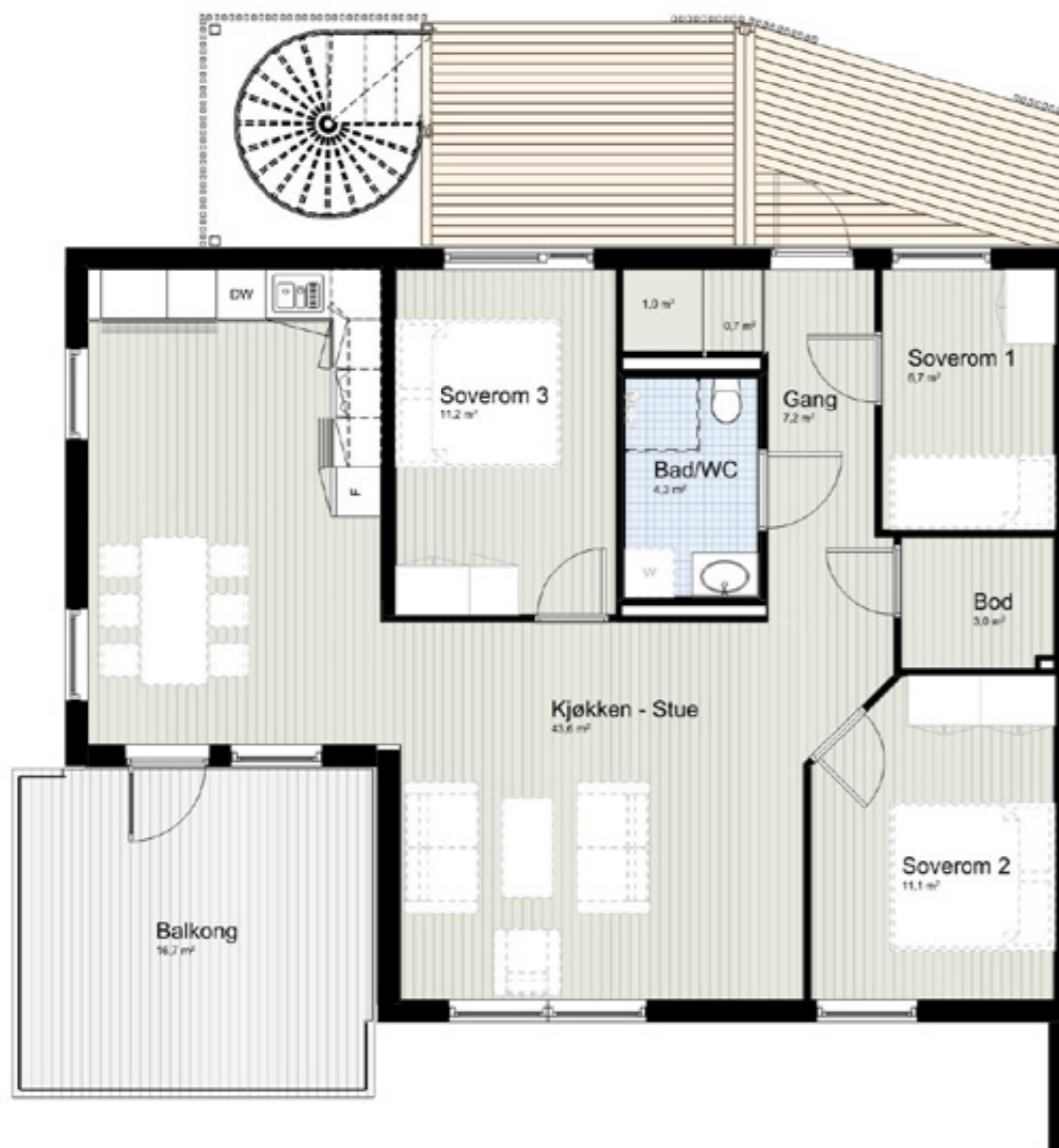
Plantegning for 2.-4. etasje for 4-roms i bygg D. For 1. etasje er det platting istedenfor balkong.
